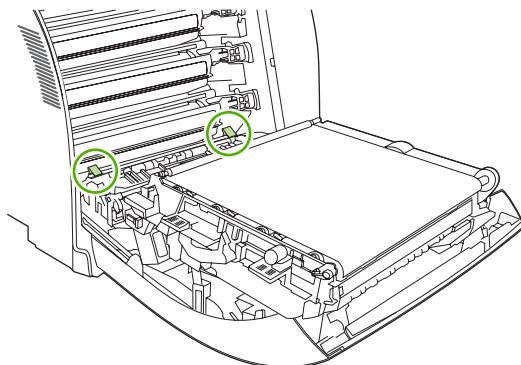
4. Нажмите на выступы и поднимите пластину регистрации. Извлеките весь замятый носитель, а затем установите пластину регистрации в закрытое положение.
