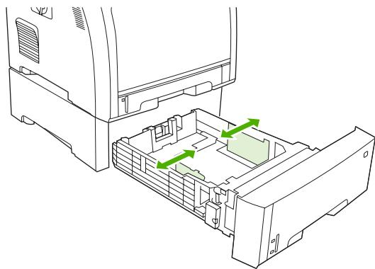
5. Загрузите бумагу в лоток. Если используется специальная бумага, например фирменный бланк, загружайте ее лицевой стороной вверх, верхним краем в направлении к передней части лотка.
