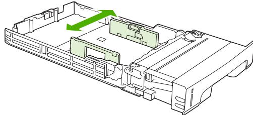
5. Загрузите бумагу в лоток. Если используется специальная бумага, например фирменный бланк, загружайте ее лицевой стороной вверх, верхним краем в направлении к передней части лотка.
