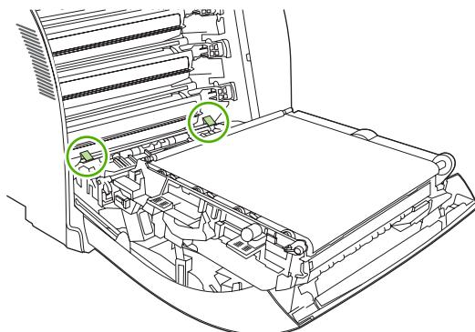
6. Нажмите на выступы и поднимите пластину регистрации. Извлеките весь замятый носитель, а затем установите пластину регистрации в закрытое положение.
