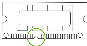
5. Придерживая модуль DIMM за края, выровняйте вырез на модуле DIMM с полоской на гнезде DIMM под углом и нажмите на модуль DIMM, чтобы он занял свою позицию. Если модуль установлен правильно, металлические контакты не видны.
