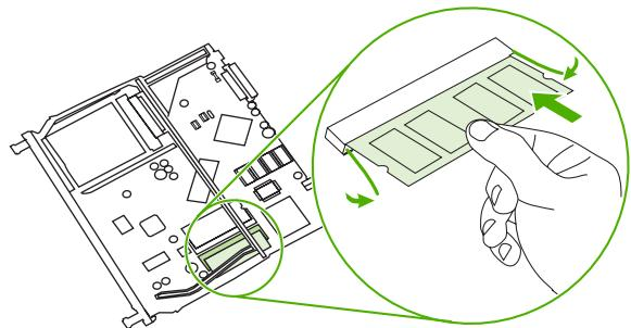
6. Нажмите на модуль DIMM, пока защелки не захватят модуль DIMM.
