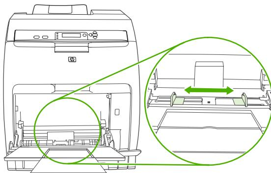
4. Загрузите не более 10 конвертов в середину лотка 1 стороной для печати вниз, причем сторона с местом для марки должна быть ближайшей к принтеру, а короткий край необходимо направить в сторону принтера. Задвиньте конверты в принтер плотно до упора, но без усилия.
