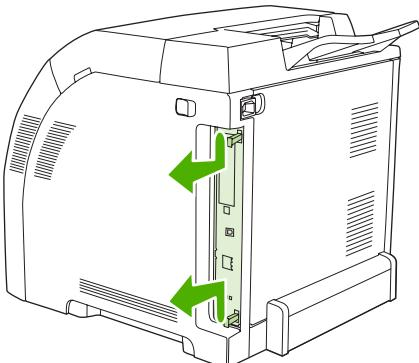
3. Поместите модуль форматера на чистую, гладкую и заземленную поверхность.
