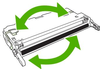
5. Снимите оранжевые фиксаторы с нового картриджа, а также извлеките ленту, прикрепленную к фиксатору слева. Утилизируйте ленту и фиксаторы в соответствии с местными нормативами.
