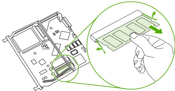
4. Извлеките новый модуль DIMM из антистатической упаковки и найдите вырез выравнивания на нижнем крае модуля DIMM.
