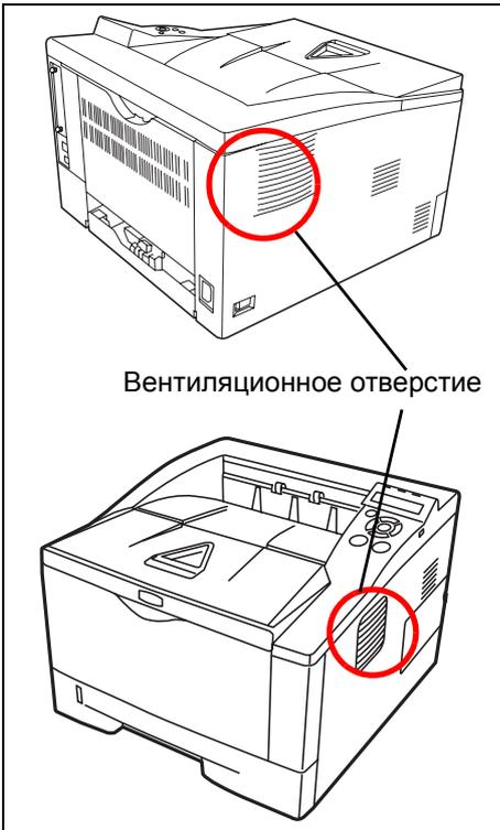
**9** Тканью без ворса очистите вентиляционные отверстия, расположенные на левой и правой панели аппарата, от пыли и грязи.
