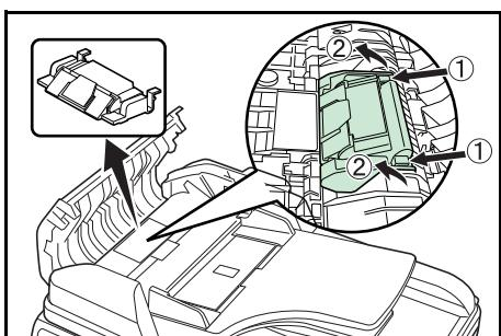
**1** Удерживая нажатыми два крючка (x2), показанные на рисунке, поднимите и удалите тормозную подложку.
